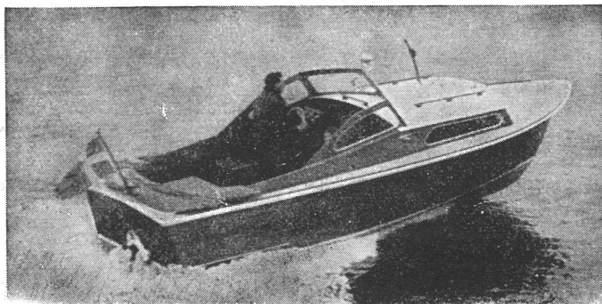
AQUA-CABIN 6.30x2.20 m, rymlig och snabb familjeruffbåt, även lämplig för vattenskidåkning. Motor: Volvo Penta Aquamatic 110, fart ca 26 knop.
